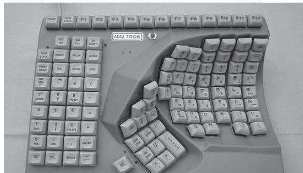
Abb. 1: Maltron-Tastatur mit ergonomischer Tastenanordnung (Quelle: <http://www.maltron.com/maltron-press.html>)
