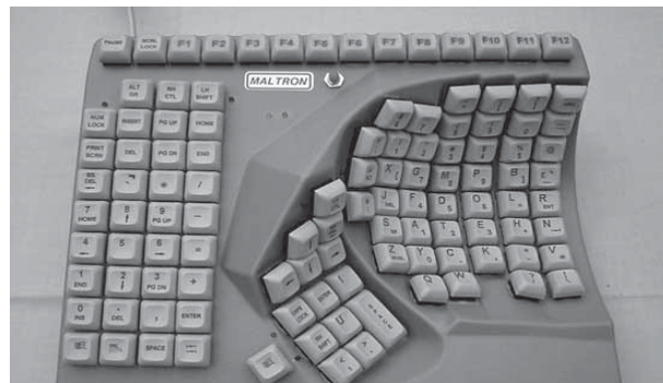
Abb. 1: Maltron-Tastatur mit ergonomischer Tastenanordnung (Quelle: http://www.maltron.com/maltron-press.html )
